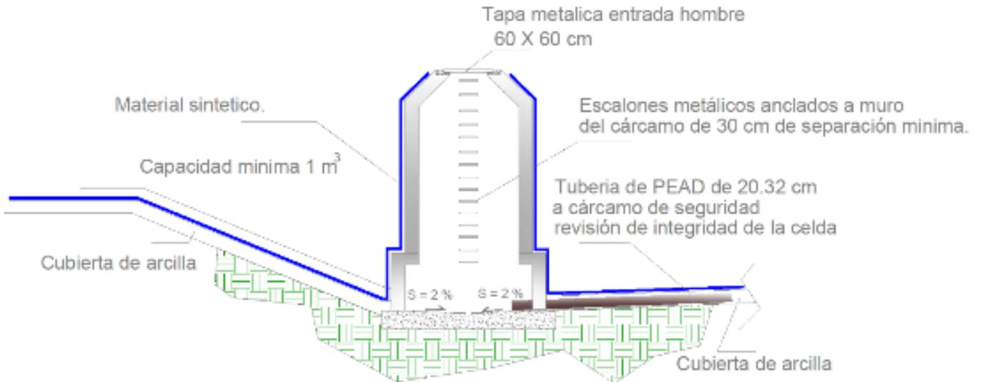
**Figura A.5. Vista superior del pozo de monitoreo en vertical para lixiviados**
