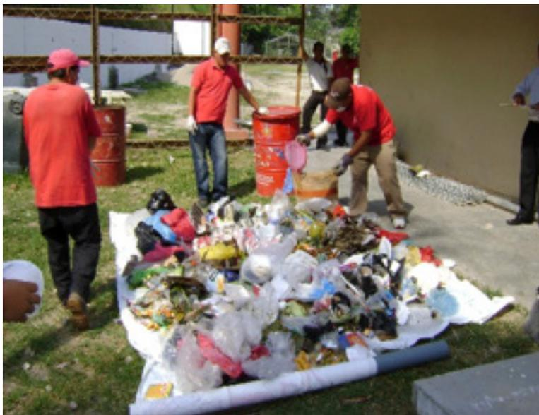
2. Homogeneizar la muestra mezclándola toda con palas, a fin de que lo que está arriba pase a la parte inferior.
