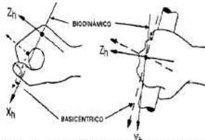
Figura 1. Sistemas biodinámicos y basicéntrico de coordenadas para la mano, con indicación de los componentes de aceleración (ISO 5349 y ANSI S3-34-1986)
